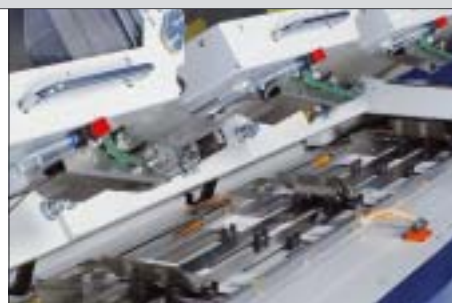
Gut zugängliche Dokumentenstrecke durch schwenkbare Beilagenanleger
