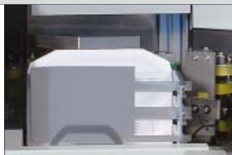
Aussteuerfach zur Aufnahme von fehlerhaften Kuverts
