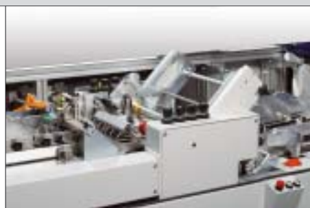
Zuführsystem 432 mit Transfermodul ohne Falztaschen für 4"-Dokumente
