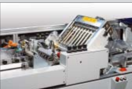
Zuführsystem 432 mit vier Automatik-Falztaschen
